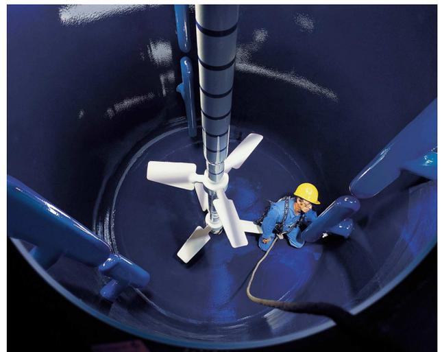
*Mezclador agitador esmaltado 16 m<sup>3</sup>, con placas de desviación soldadas en la pared y completamente esmaltadas.*
